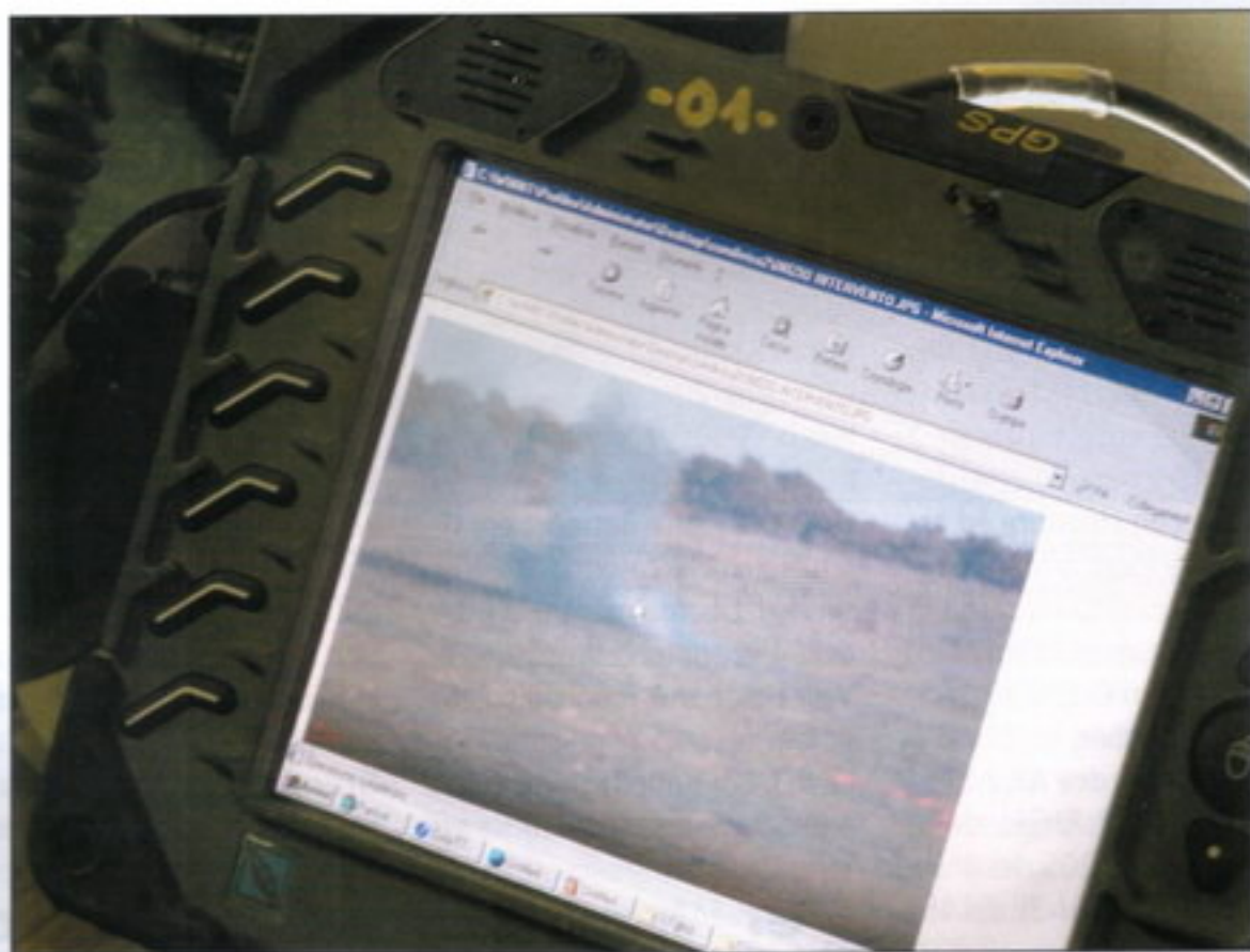
L'immagine del carro distrutto all'interno del poligono di Monteromano come appare sul PC LRT-330 della sala operativa del Task Group. Dal distaccamento al TG l'immagine ha impiegato 30/40 secondi (Batacchi).
